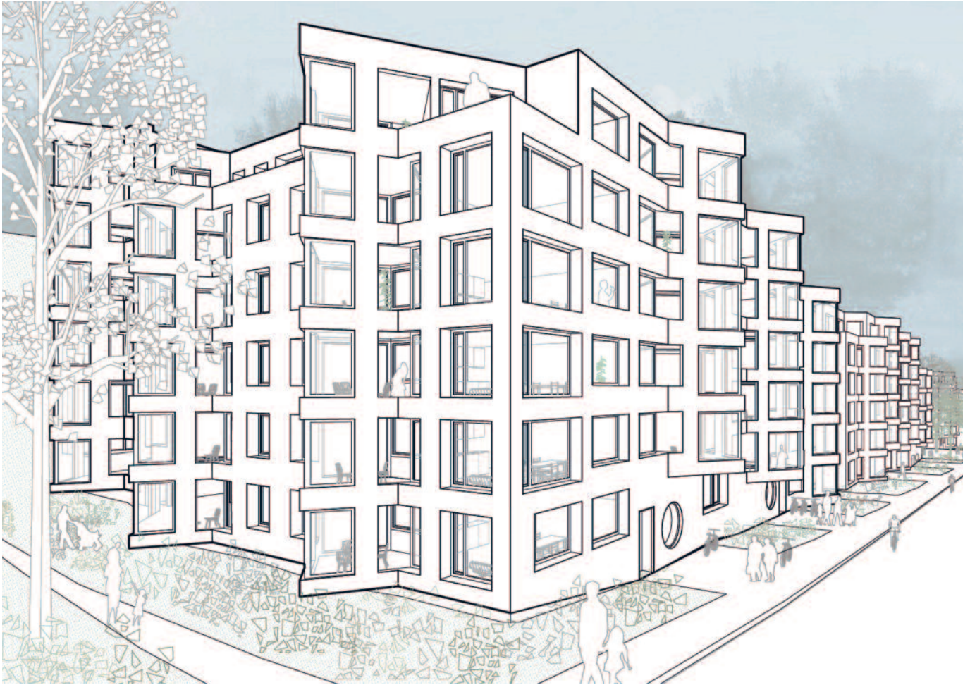
Visualisierung des Konstruktionsprinzips mit den lärmschützenden Grosserkern.
