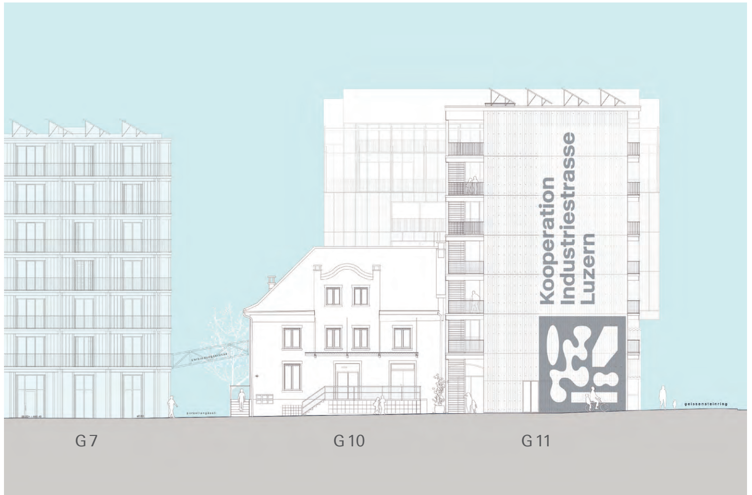
An der Ecke Industriestrasse/Geissensteinring grenzt das abl-Gebäude 11 an den Bestandsbau Gebäude 10 des Wohnwerks (heute Sinnlicht). Dazwischen dient der Laubengang als Zugang zu den abl-Wohnungen.
