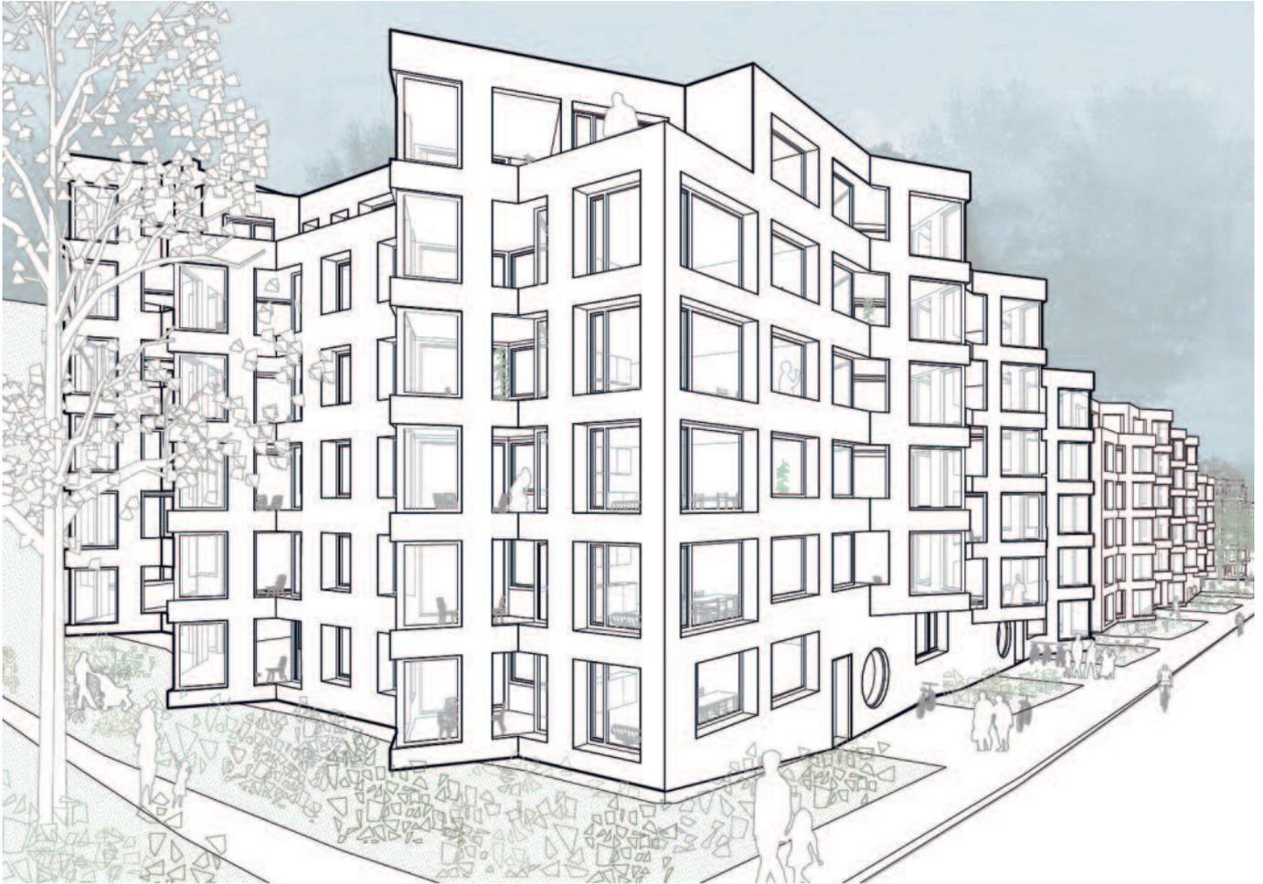
Visualisierung des Konstruktionsprinzips mit den lärmschützenden Grosserkern.
